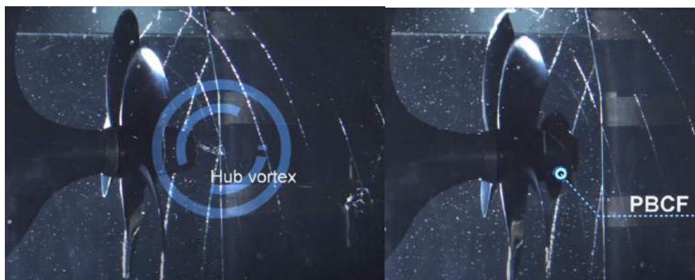
Ilustración 41 eliminación de vórtices con PBCF fuente Wärtsilä
